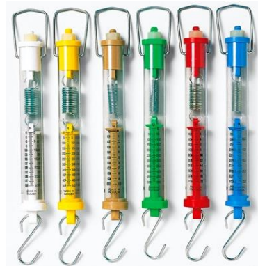
Figuur 10: De krachtmeters die je in Hfd1 bent tegengekomen. Hoe harder je er aan trekt, hoe verder ze uitrekken.
