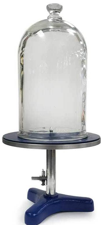
Figuur 42: Een vacuümstolp. De lucht onder de stolp van worden weggepompt via het kraantje.
