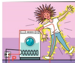
b Bij punt P raakt een draad het metalen omhulsel. Er loopt nu via jou een stroom de aarde in.
