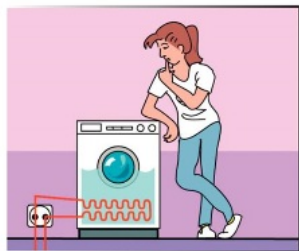
6.21a De stroom loopt door het verwarmingselement. De rode lijn geeft de weg aan die de stroom volgt.
