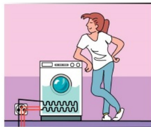
c Een geaard stopcontact voert de stroom naar aarde af, een gevaarlijke situatie wordt zo voorkomen.
